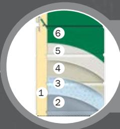
Pannelli ad alta efficienza energetica. Doppia lamina zincata con riempimento di poliuretano senza CFC. 1. 40 mm di isolamento. 2. Lamiera. 3. Zincatura. 4. Primer. 5. Verniciatura. 6. Colorazione o pellicola simil legno.
